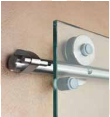
MOTION 600 Führungsschiene aus massiver Edelstahlstange mit einem Durchmesser von 25 mm, Oberfläche Edelstahl gebürstet. Glasstärke ESG 10 mm.
